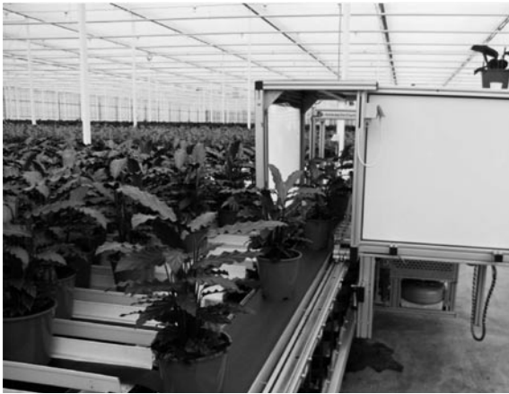
図 3. 鉢物を移動させるベルトコンベアと選別を行う 3D カメラを収納した箱
